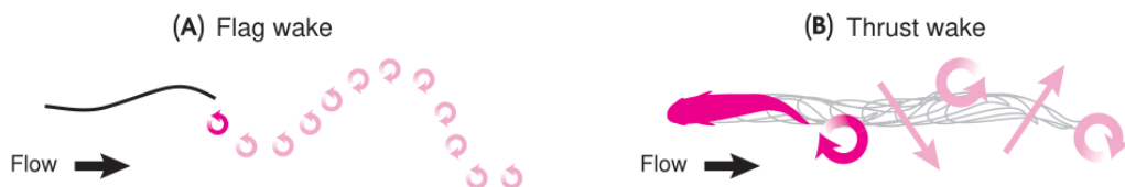
FIGURE 1.52 – Tourbillons (cercles) et jets d'écoulement (flèches) derrière (a) un drapeau passif et (b) un poisson nageant dans un écoulement d'eau [Müller, 2003].
