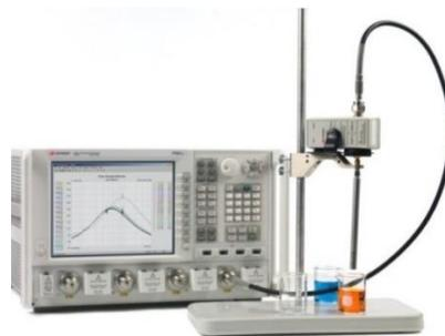
**Figure 5. 6 :** Kit de mesure diélectrique par sonde coaxiale ouverte- KEYSIGHT TECHNOLOGIES® N1500A [226].
