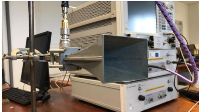
**Figure 5. 10 :** Banc de mesure expérimental basé sur une antenne cornet (SIVERSIMA PM 7320X/01) connectée à l'analyseur de réseaux vectoriel Agilent N5242A.
