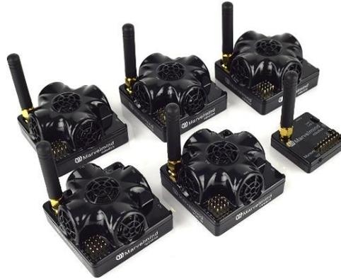
**Figure 4. 7 :** Modem et balises du système de navigation indoor Marvelmind.
