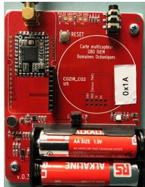
Figure 5-7: Module THLN: (Capteurs de Température, Humidité, Luminosité et Bruit)
