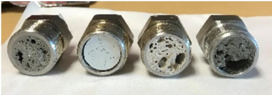
FIGURE 3.33 – État des ciments colle après une recuit.
