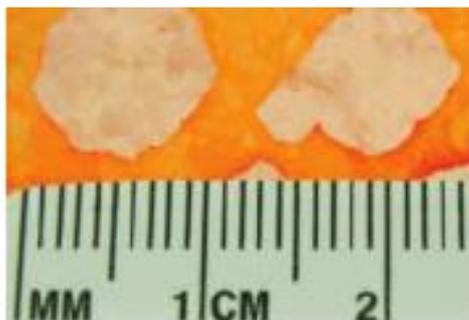
Figure I-14: Monocristaux de graphène de taille centimétrique synthétisés sur cuivre par méthode CVD. Les monocristaux de graphène ont une couleur beige [4]
