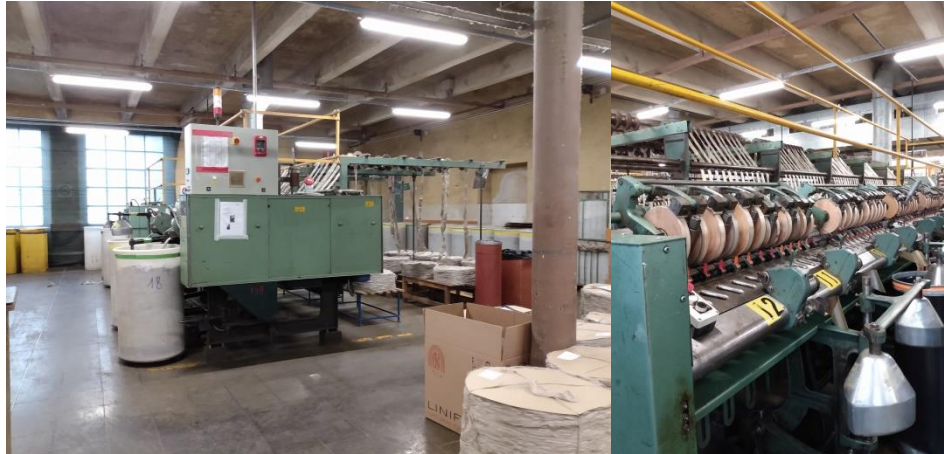
Figure 1-21 : Etirage des rubans (Linificio e Canapificio Nazionale)
