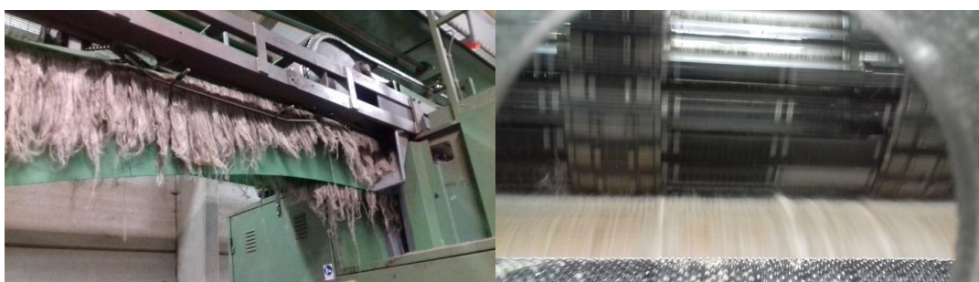
Figure 1-13 : Peignage des fibres de lin (Terre de Lin)
