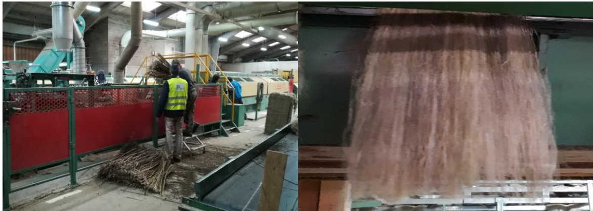
Figure 1-17 : Teillage et peignage du chanvre [20]
