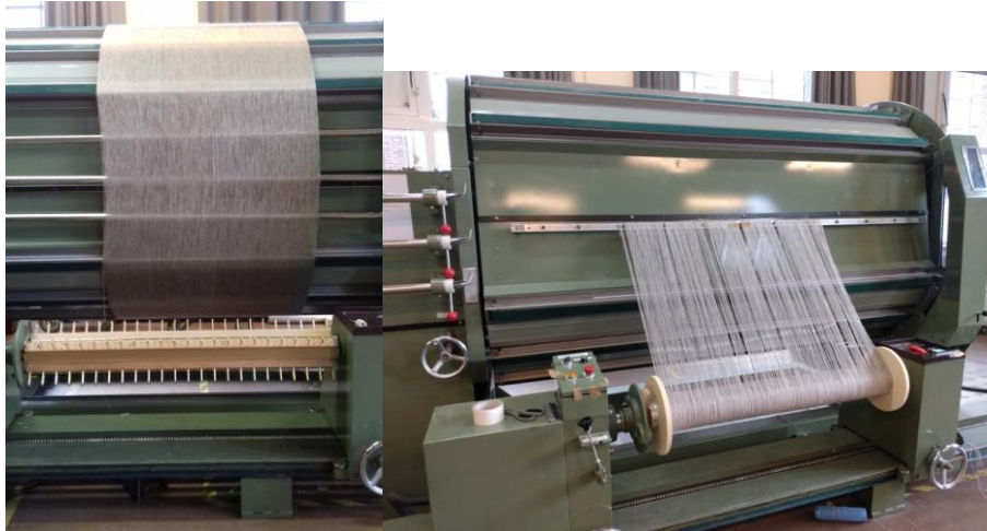
Figure 1-35 : Etape d'ourdissage (ENSAIT)
