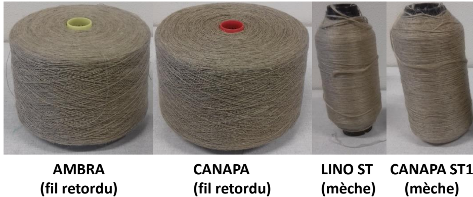
Figure 2-1 : Fils retordus et mèches sans traitement (ST)
