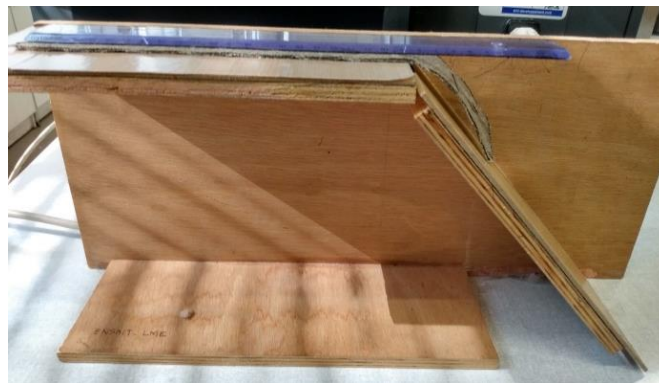
Figure 3-16 : Banc d'essai du cantilever test pour la tenue en flexion à l'état sec
