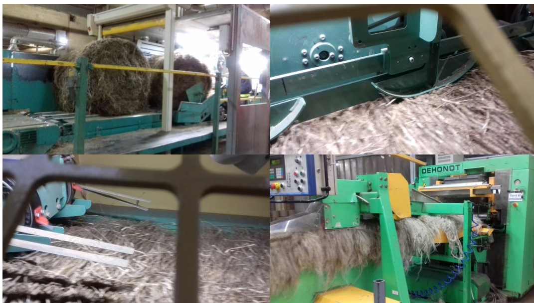
Figure 1-12 : Teillage des pailles de lin (Terre de Lin)
