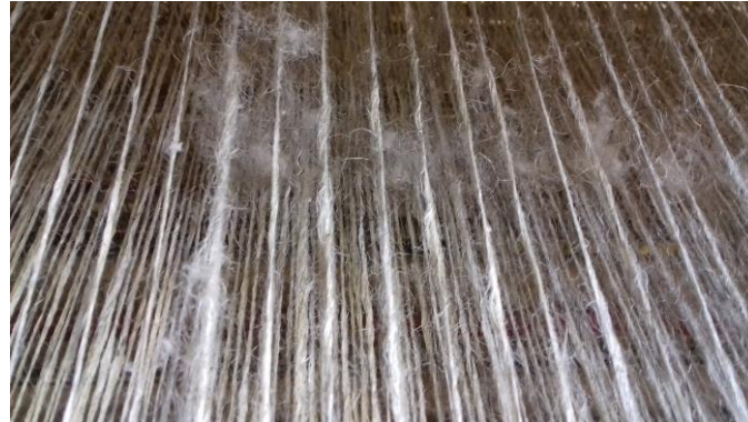
Figure 2-2 : Pilosité des fils pendant le tissage
