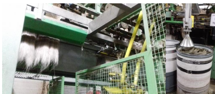
Figure 1-14 : Mise en pot des rubans de lin (Terre de Lin)
