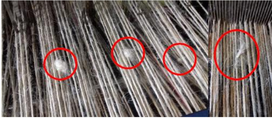
Figure 1-38 : Dégradation des fils de lin pendant le tissage [124]
