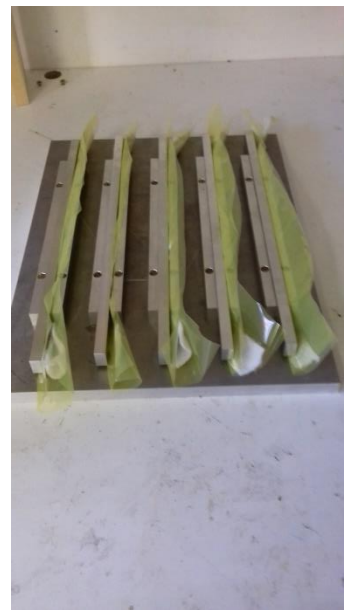
Figure 2-19 : Moule IGBT en cours de fabrication
