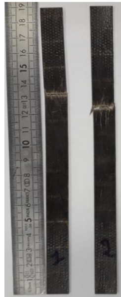
Figure 4-8 : Eprouvettes CQUD en sens fibres après essais de traction
