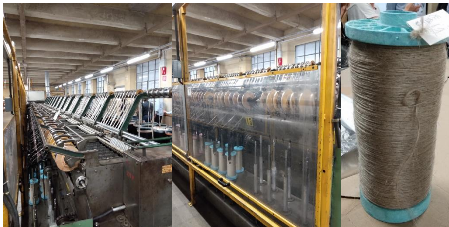
Figure 1-22 : Production des mèches (Linificio e Canapificio Nazionale)
