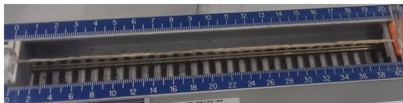
Figure 2-45 : Ondulation résiduelle des fils après tissage
