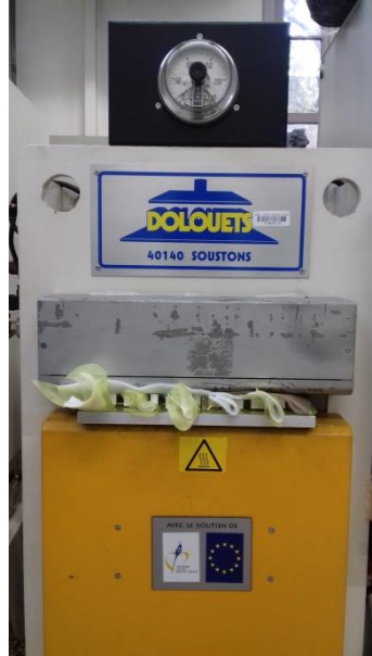
Figure 2-20 : Moule IFBT en cuisson dans la presse chauffante
