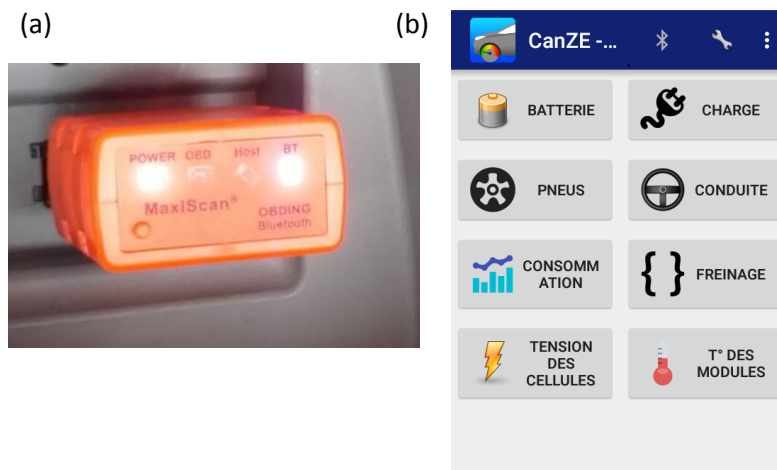
Figure II.5 : système de mesure de la Renault Zoé : (a) lecteur OBD (b) application utilisée
