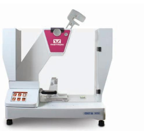
Figure 3.26 – Système à choc pendulaire Instron CEAST 9050
