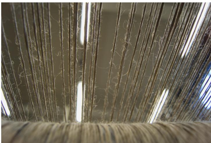
Figure 3.41 – Pilosité de l'ensouple avant d'entrer dans la machine à tisser
