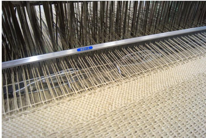
Figure 2.3 – Échange d'un fil de trame par deux lances au cours du tissage
