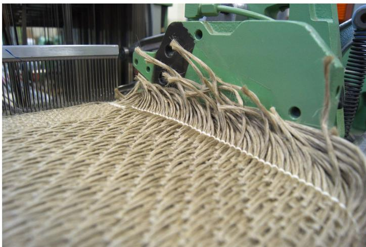
Figure 2.8 – Lisière réalisée en fil de coton de faible titrage
