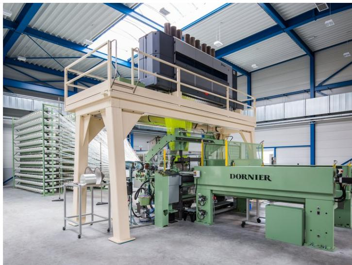
**Figure 1.14** – Machine à tisser LINDAUER DORNIER destinée à la réalisation de structures épaisses [120]
