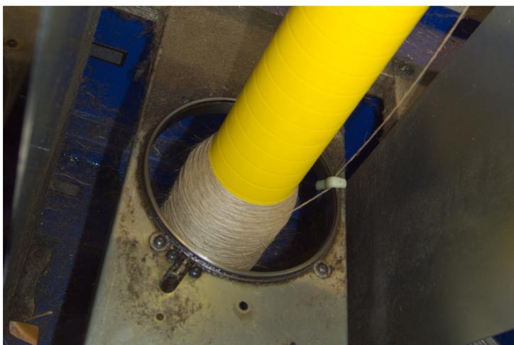
**Figure 3.2** – Retordeuse à anneaux TWISTEC 3
