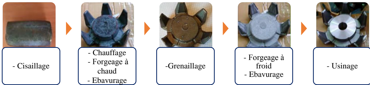
Figure I. 10 : Procédés de fabrication d'une roue polaire.
