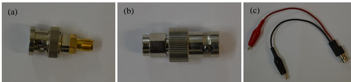
Figure 2.4.1-3. Adaptateurs (a) SMA mâle/BNC femelle, (b) SMA femelle/BNC mâle et (c) BNC femelle/pinces crocodiles
