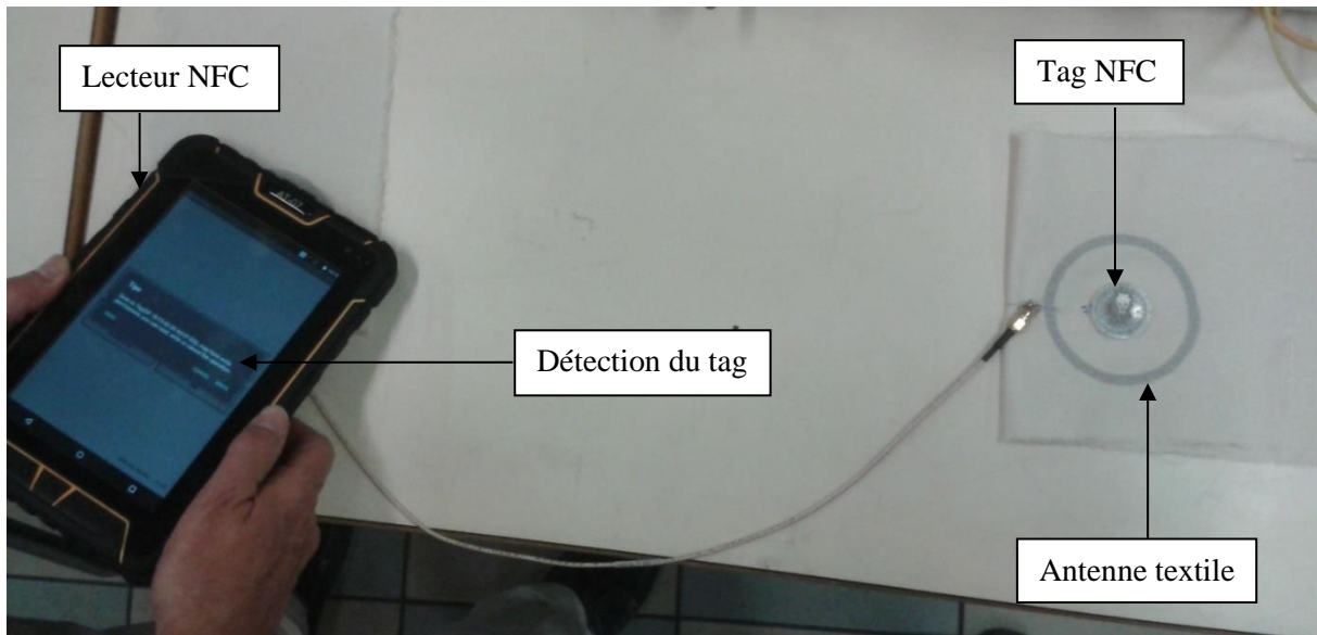
Figure 3.5.2-1. Montage expérimental de la preuve de concept du transfert de données au travers des antennes NFC textiles à 12 spires, de 40 mm de rayon extérieur et de 0,75 mm d'écartement entre deux lignes de courant
