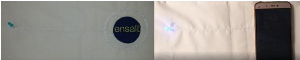
Figure 3.5.1-1. Preuve de concept du transfert d'énergie en entre un smartphone et une antenne à 6 spires, de 40 mm de rayon et de 0,75 mm d'écartement entre les lignes de courant avec une ligne de transmission de 200 mm connectée à une DEL. A gauche, le prototype sans le smartphone avec le logo « ENSAIT » matérialise la zone où le placer : la DEL est éteinte. A droite, le prototype avec le téléphone portable avec le mode NFC activé est placé sur l'antenne : la DEL est allumée.
