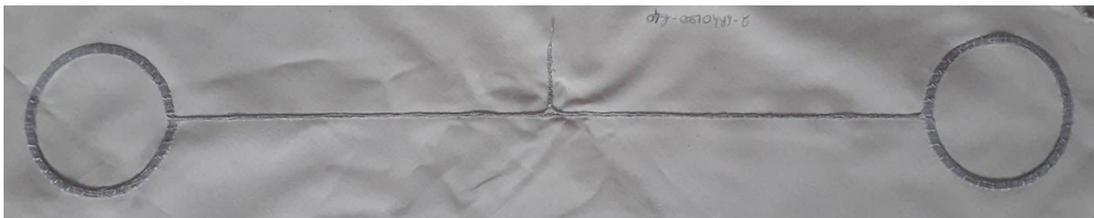
Figure 2.3.2-8 Prototype de relais NFC textile intégrale composé de deux antennes, de 6 spires de rayon extérieur de 40 mm, d'une ligne de transmission de 200 mm et d'une longueur de capacité d'ouverture de 30 mm
