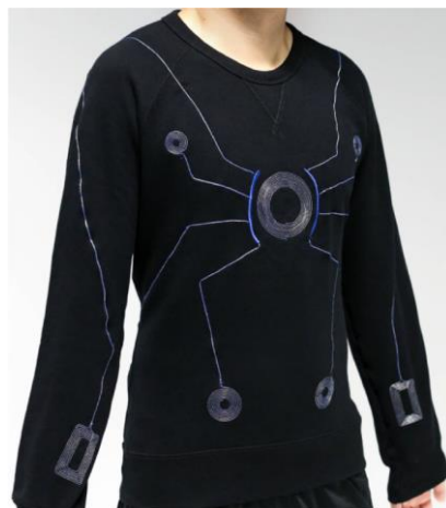
Figure 1.4.3-3. Prototype de tee-shirt connecté créant un réseau de communication sans fil autour du corps [90]
