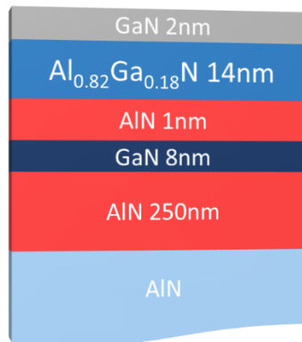
Figure 5.7 : Schéma de structure AlGaIn/AlN sur substrat AlN.
