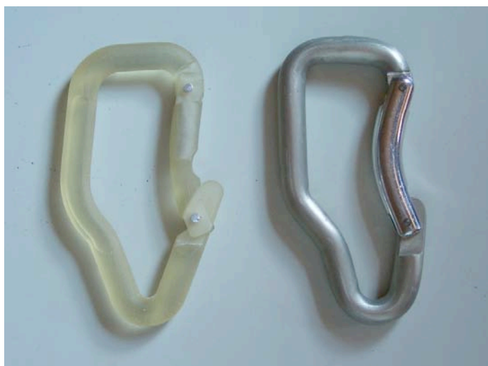
Figure 6-1 : prototypes en résine et en Zicral du mousqueton
