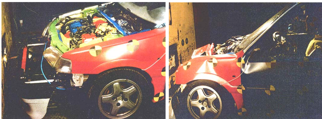
Figure 2-14 : véhicule prototype avant et après le crash
