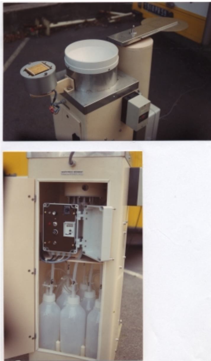
Figure 7 : Collecteur de précipitation du réseau MERA.
