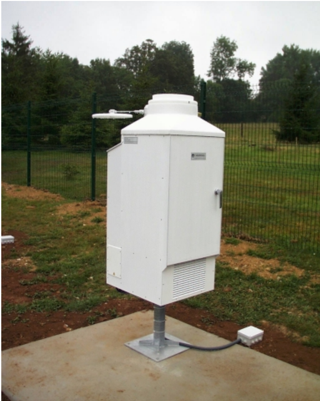
Figure 8 : Nouveau collecteur de précipitation du réseau MERA (le NSA 181/KHS de la société Eigenbrodt) .
