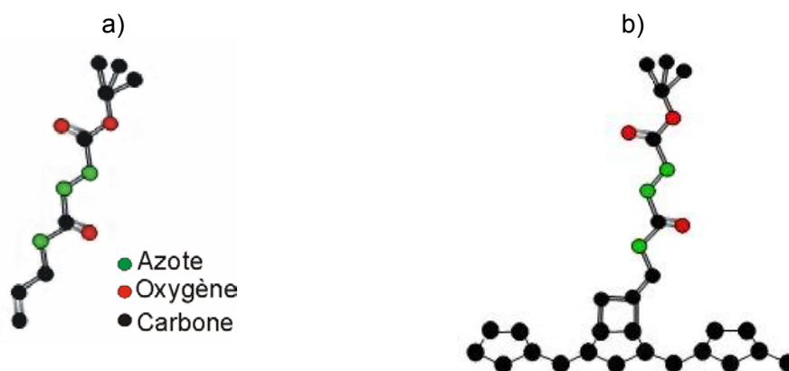
Fig. 5.1: a) Structure chimique de la molécule (1) tert-butyl 2-[(allylamino)carbonyl]hydrazinecarboxylate ; b) structure chimique de la molécule (1) après réaction du groupe alkène avec un dimère de silicium.
