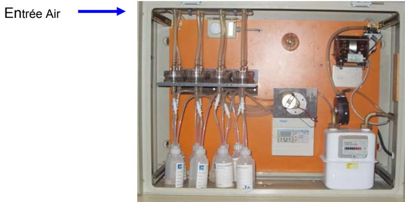
**Figure 9 : Echantillonneur des composés soufrés du dispositif MERA**
