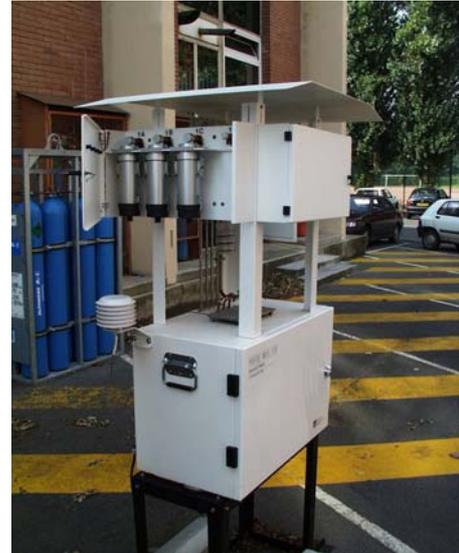
**Figure 23 : Schéma fluide et photo du système de prélèvement PARTISOL 2300 (Rupprecht & Patashnik)**
