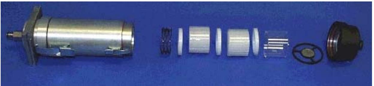
**Figure 22 : Système Denuder/filterpack, denuder en nid d'abeille type CHEMCOMB (Rupprecht & Patashnik)**
