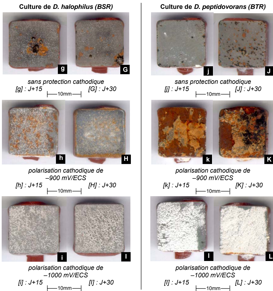
Figure 10 : photographies prises à la loupe binoculaire de la surface des éprouvettes après 15 jours et 30 jours d'essai. Essais en cultures pures
