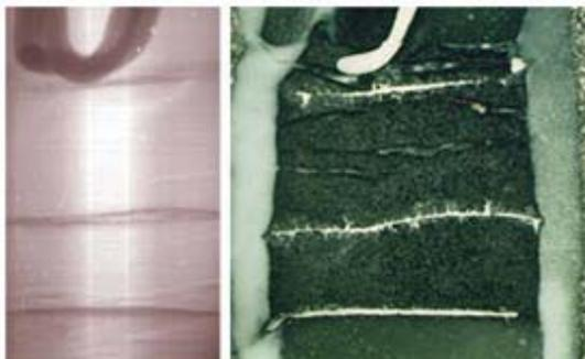
**Figure A3 :** Radiographies d'échantillons d'olivine  $\text{Mg}_2\text{SiO}_4$  (longueur totale  $\sim 2,5$  mm) vues dans la presse à  $1000^\circ\text{C}$  et 7 GPa, et photo du produit d'expérience. Des feuilles de métal, absorbant fortement les rayons X, séparent les échantillons. La soudure du thermocouple est visible en haut des deux images, ainsi que (à gauche) le faible contraste d'absorption X des enclumes en cBN utilisées pour cette expérience.
