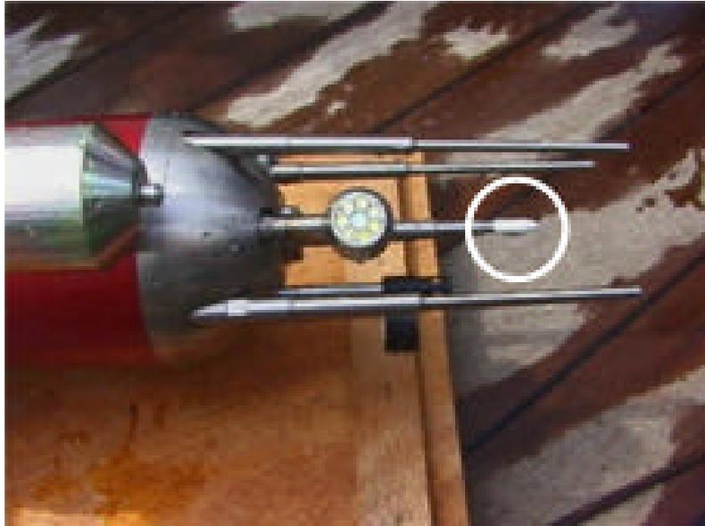
**Fig. 2.** Visualisation du capteur de cisaillement turbulent (cercle blanc) sur la partie antérieure du profileur à haute fréquence (256 Hz) "TurboMAP". Une description plus détaillée du profileur "TurboMAP" sur lequel a porté une partie de mes recherches post-doctorales sera fournie dans la section 3.1.
