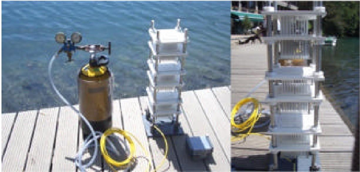
**Fig. 15.** Echantillonneur tridimensionnel “*Micro3DMapper*”, développé et construit à la Station Marine de Wimereux et dévoué spécifiquement à l’échantillonnage des virus, bactéries et cellules phytoplanctoniques. Chacune des trois couches est composée de 100 seringues de 1 ml séparées de 1 cm.
