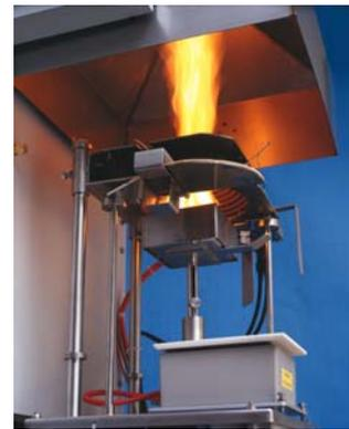
**Figure 56.** Calorimètre à cône.
