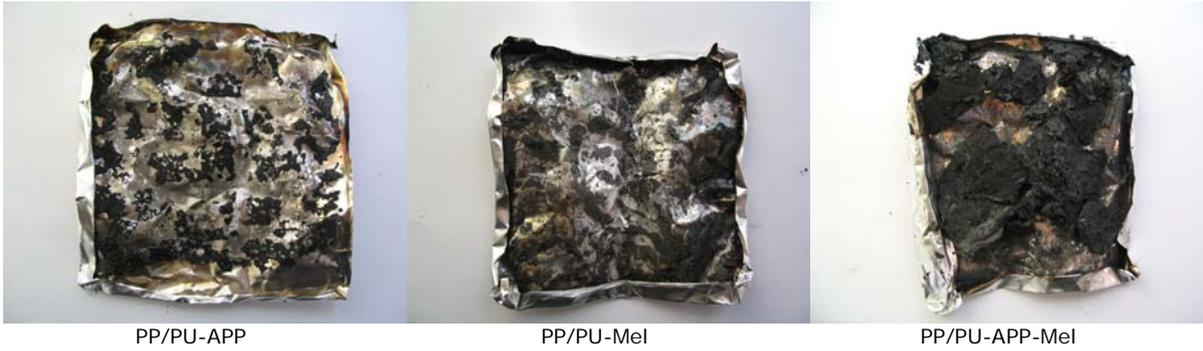
**Figure 76.** Résidus issus du cône calorimètre des échantillons enduits.
