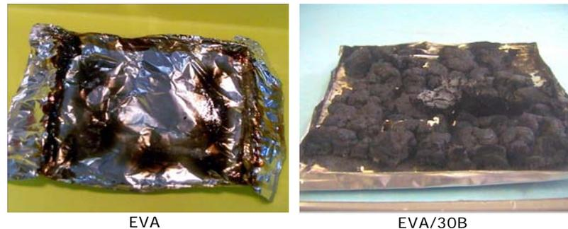
**Figure 133.** Photos des résidus obtenus après essai au cône calorimètre
