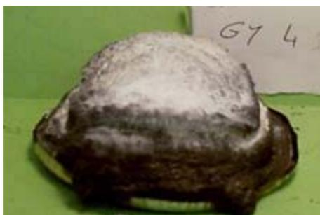
**Figure 46.** Résidu obtenu après 20 min d'exposition à une irradiance de 75kW/m<sup>2</sup> dans les conditions du cône calorimètre (Peinture intumescente à base de résine A+D).
