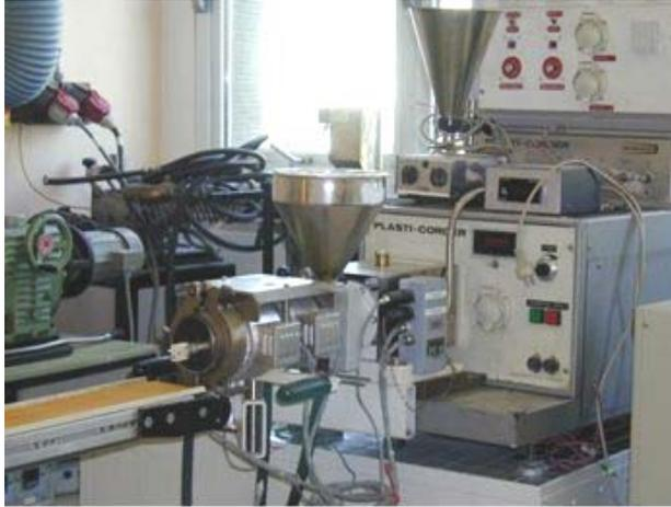
**Figure 53.** Extrudeuse bi-vis contrarotative de Brabender.
