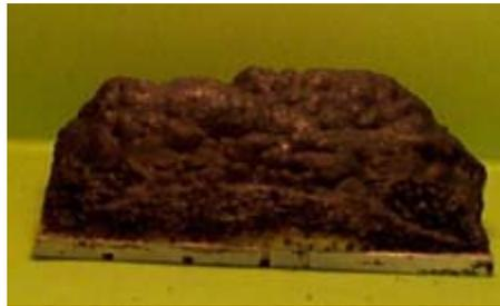
**Figure 43.** Résidus obtenus après 20 min d'exposition à une irradiance de 35kW/m<sup>2</sup> dans les conditions du cône calorimètre (35kW/m<sup>2</sup>).
