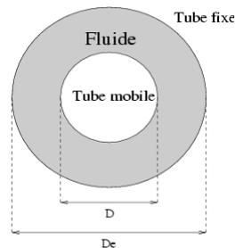
Figure 38 : Configuration de type cylindres coaxiaux.
