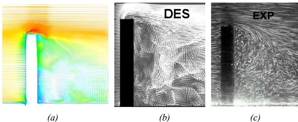
Figure 55 : Ecoulement derrière un barreau : (a) LES, (b) DES, (c) Expérimental (Afgan et al. 2005).
