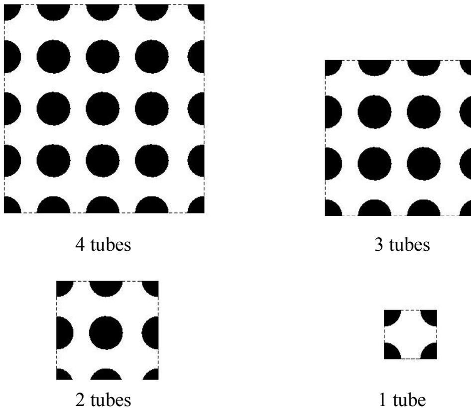
Figure 6 : Exemples de cellules périodiques utilisées pour les calculs en faisceaux avec 1, 2, 3 ou 4 tubes pleins dans chaque direction transversale.
