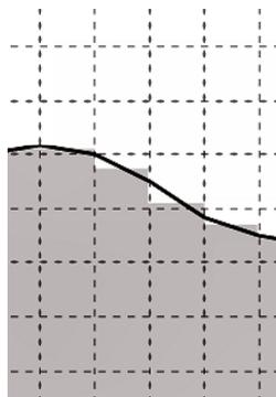
Figure 60 : Exemple de gestion d'une interface fluide structure avec une formulation non A.L.E. de type Chimère.
