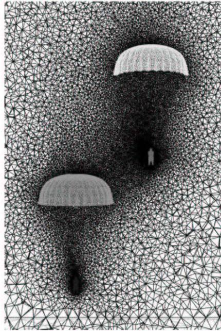
Figure 58 : Exemple de couplage fluide structure en présence de plusieurs structures couplées.
