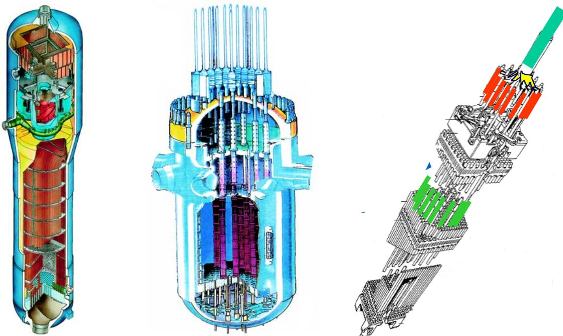
Figure 1 : Générateur de vapeur (à gauche), cuve de réacteur (au milieu), grappe de commande insérée dans un assemblage combustible (à droite).
