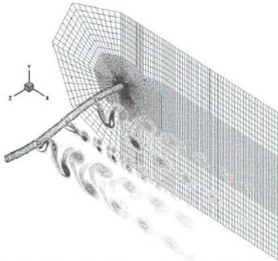
Figure 65 : Exemple d'identification des sources d'incertitudes pour un écoulement turbulent autour d'un cylindre (Lucor 2004, Lucor et Karniadakis 2004).
