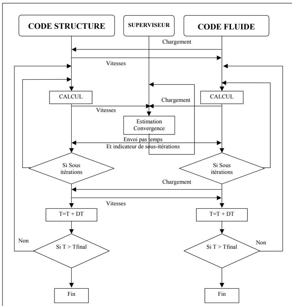
Figure 36 : Procédure de couplage dynamique.
