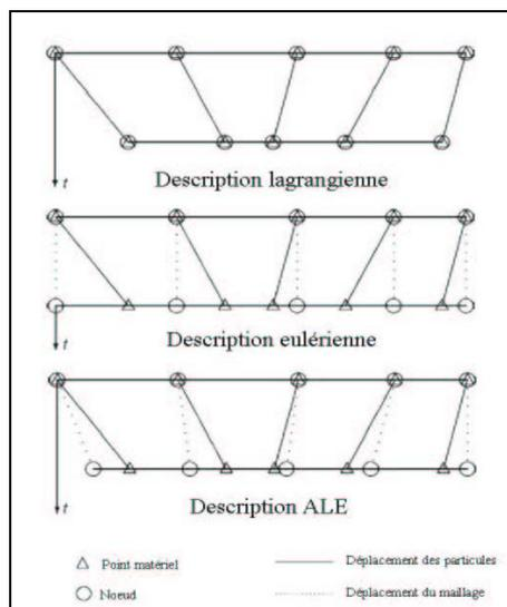
Figure 28 : Principe de la gestion de maillage déformable avec une formulation A.L.E.
