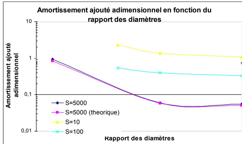
Figure 44 : Amortissement ajouté en fonction du rapport des diamètres des tubes coaxiaux pour différents nombres de Stokes en fluide visqueux (10, 100, 5000). Comparaison entre les solutions numériques et analytiques (Chen et al. 1976, 1977).
