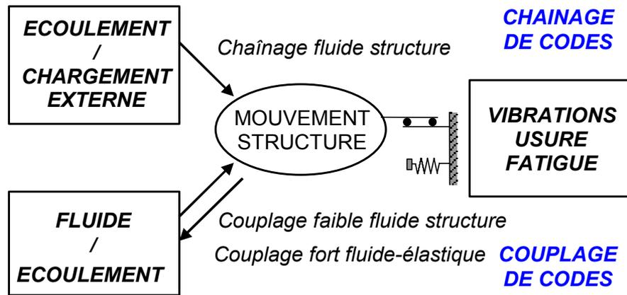
Figure 3 : Classification des problématiques de chaînage fluide structure, couplage fluide structure et couplage fluide-élastique.
