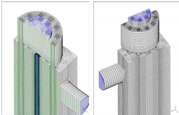
Figure 15 : Représentation par parties du maillage du domaine fluide de la configuration (maillage conforme comprenant environ 1 million d'éléments).
