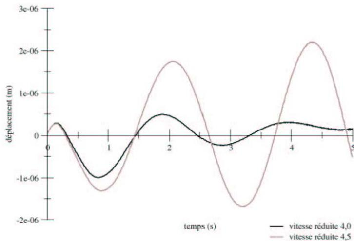
Figure 49 : Signal de déplacement d'un point de la structure flexible pour deux valeurs de la vitesse réduite en-deçà et au-delà de la vitesse critique de départ en instabilité.
