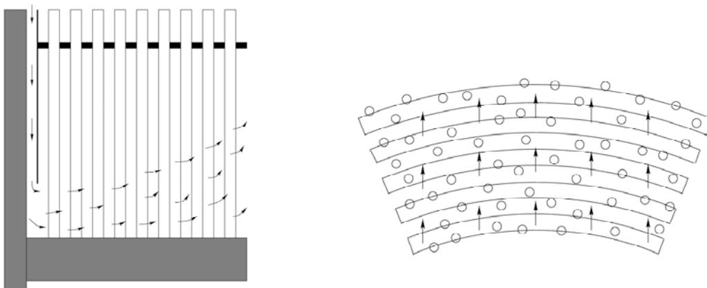
Figure 62 : Représentation schématique de portion de faisceau de tubes de générateur de vapeur avec des écoulements monophasiques transverses ou obliques en partie basse (à gauche) et diphasiques transverses ou obliques dans la zone cintrée des tubes en partie haute (à droite).
