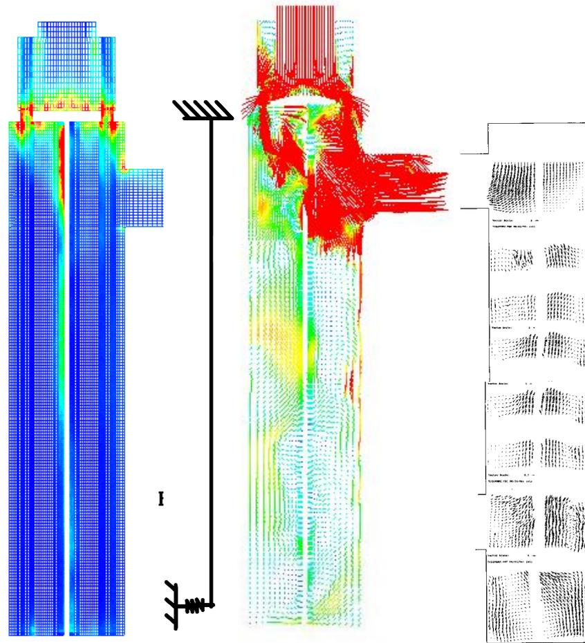
Figure 16 : Distribution de l'énergie turbulente (à gauche), champs de vitesses autour du tube estimés numériquement par L.E.S (au milieu) et expérimentalement par vélocimétrie laser (à droite).
