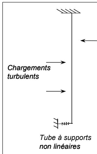
Figure 19 : Représentation du tube soumis à une excitation turbulente, encastré en haut et supporté non linéairement par une butée à chocs en bas.
