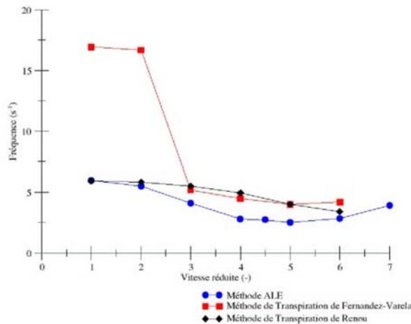
Figure 50 : Fréquence des vibrations du cylindre en fonction de la vitesse réduite estimée avec Cosmethyc et avec une méthode de transpiration (Renou 1998, Fernandez Varela 2001).
