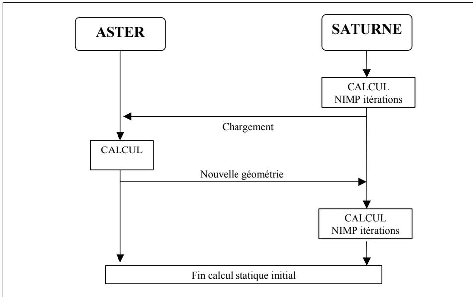
Figure 35 : Procédure de couplage quasi-statique.
