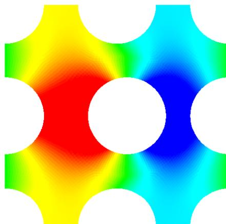
Figure 47 : Cellule périodique de faisceau de tubes en fluide au repos. Tube central plein mobile libre, tubes coupés fixes.
