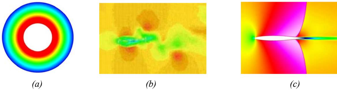
Figure 27 : Exemple d'effets induits par couplage fluide structure : (a) effet d'inertie induit par le fluide au voisinage d'une structure, (b) effet d'amortissement induit par un écoulement siège d'instationnarités générées par couplage, (c) effet de raideur induit par apparition d'une instabilité statique.
