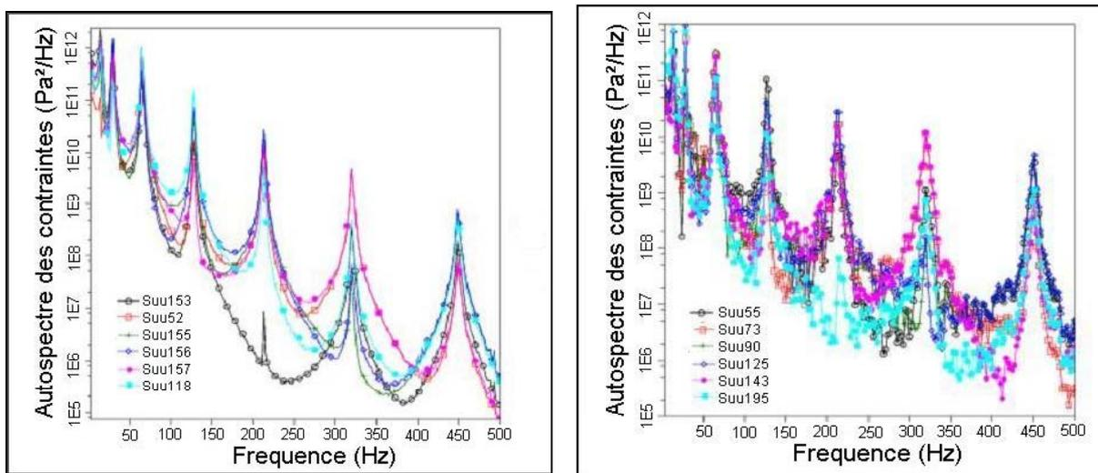
Figure 18 : Comparaison des réponses généralisées du tube obtenues à partir des chargements estimés numériquement par L.E.S. (à gauche) et expérimentalement sur maquette (à droite).
