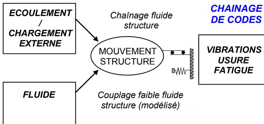
Figure 13 : Configuration de type chaînage fluide structure simulée par chaînage de codes fluide et structure (les effets de couplage faible induits par la présence du fluide étant modélisés).
