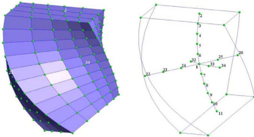
Figure 32 : Exemple de recherche de connectivité entre nœuds par la méthode des adjacents.
