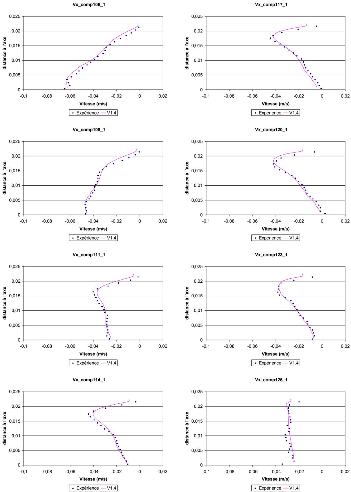
Figure 31 : Exemples de vitesses axiales instantanées d'un fluide lors de la phase de compression d'un piston de mouvement harmonique en configuration axisymétrique. Comparaison des valeurs numériques obtenues avec une formulation A.L.E. de type Laplacien et des données expérimentales mesurées.
