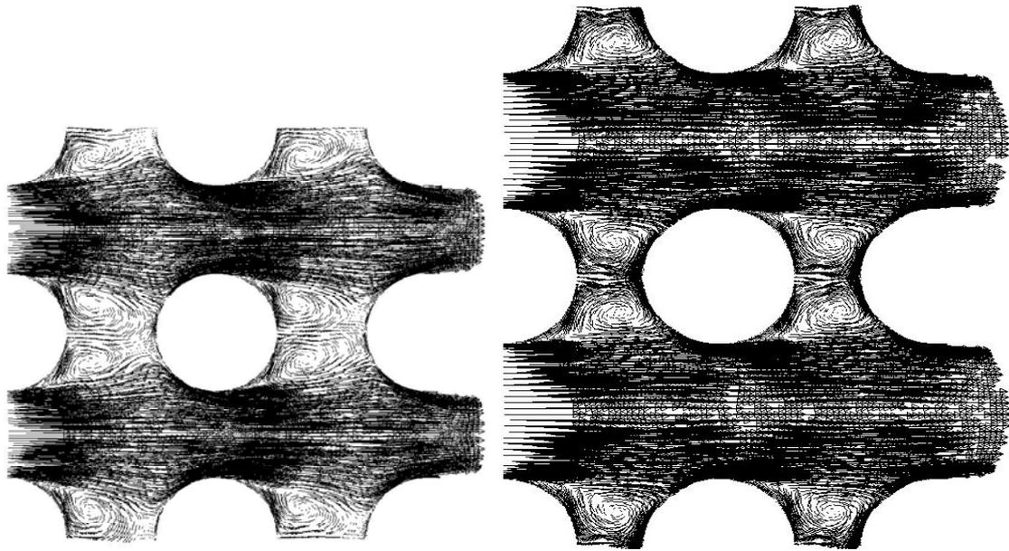
Figure 8 : Champ de vitesse moyen pour une cellule de faisceau périodique à 2 tubes avec une longueur égale à un diamètre dans la direction longitudinale, pour un faisceau à pas carré de pas réduit 1.75 (à gauche) et un faisceau rectangulaire de pas réduits 1.44 et 2 (à droite).
