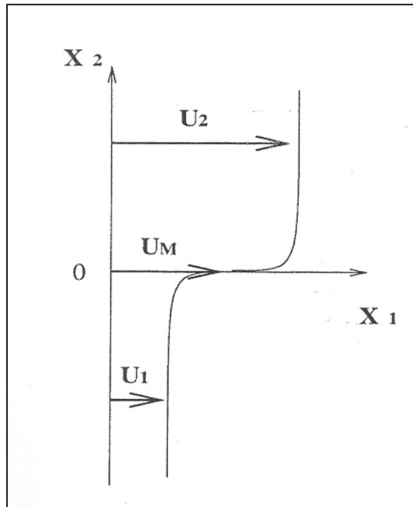
Figure 9 : Exemple de profil moyen de vitesse d'une couche cisailée en  $\tanh$  générée par des écoulements de vitesses différentes de part et d'autre d'une lame mince.
