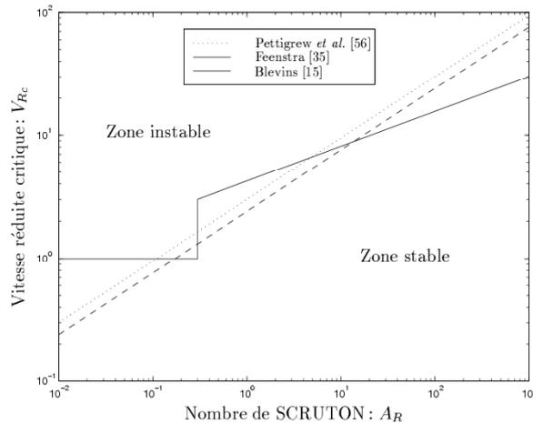
Figure 64 : Exemple de carte d'instabilité pour un faisceau de tubes sous écoulement transverse fournissant la vitesse réduite critique en fonction du nombre de Scruton (défini à partir de la masse structure en eau, de l'amortissement structure en air, du diamètre du tube et de la masse volumique du fluide, Connors 1978).
