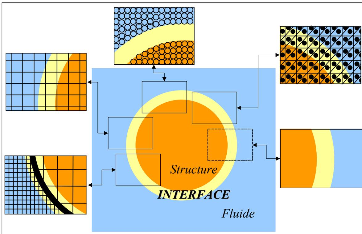
Figure 4 : Modélisation de l'interface fluide structure.
