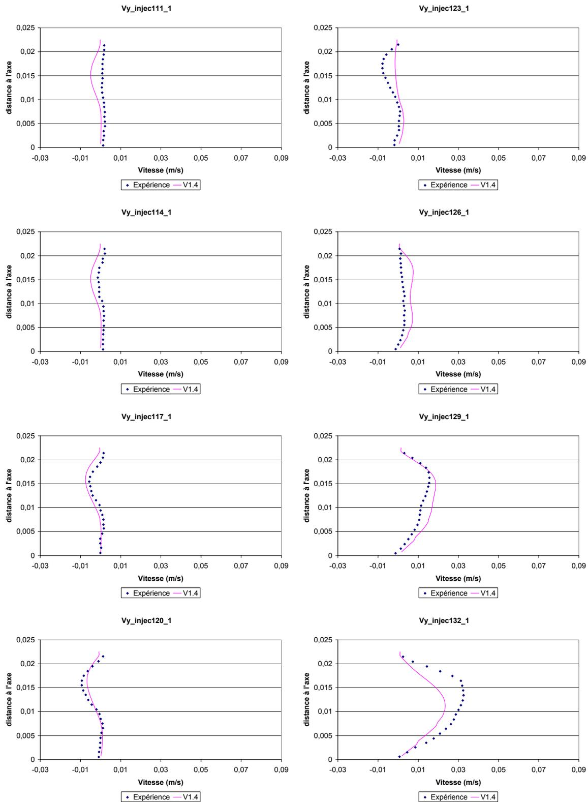
Figure 30 : Exemples de vitesses radiales instantanées d'un fluide lors de la phase d'injection d'un piston de mouvement harmonique en configuration axisymétrique. Comparaison des valeurs numériques obtenues avec une formulation A.L.E. de type Laplacien et des données expérimentales mesurées.
