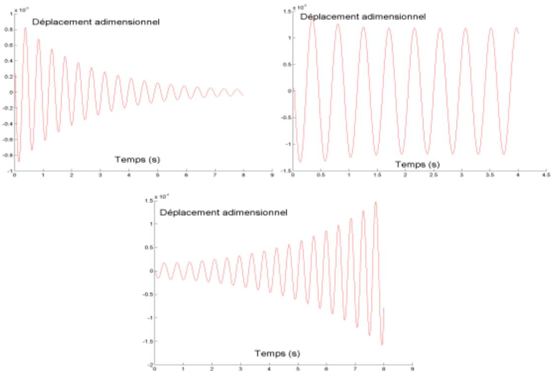
Figure 52 : Identification de la vitesse critique de départ en instabilité d'un tube dans un faisceau de tubes soumis à un écoulement transverse. Signal de déplacement du tube pour une vitesse réduite inférieure (en haut à gauche), égale (en haut à droite) et supérieure (en bas) à la vitesse critique.
