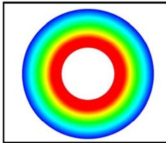
Figure 42 : Module du déplacement du maillage pour une configuration cylindres coaxiaux en fluide au repos, tube interne mobile libre et tube externe fixe.
