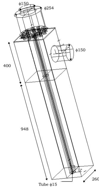
Figure 14 : Représentation schématique de la configuration comprenant un tube, dans une enceinte non confinée, soumis à un écoulement turbulent d'incidence axiale, issu d'une tuyauterie située en partie haute, traversant une plaque perforée génératrice de turbulence et évacué par une sortie latérale.
