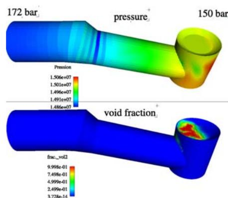
Figure 57 : Simulation de création de vapeur au niveau du clapet d'un robinet dans des conditions thermohydrauliques caractéristiques d'un fonctionnement en ouverture rapide avec génération d'un effort de pression sur la tige de commande pouvant conduire à un problème de manœuvrabilité (Mimouni et al. 2006).
