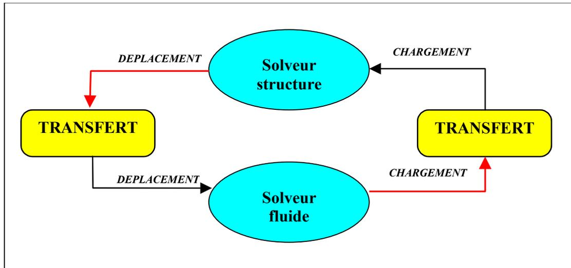
Figure 34 : Principe du pilotage des transferts de données spatiales entre solveurs dans Cosmethyc.
