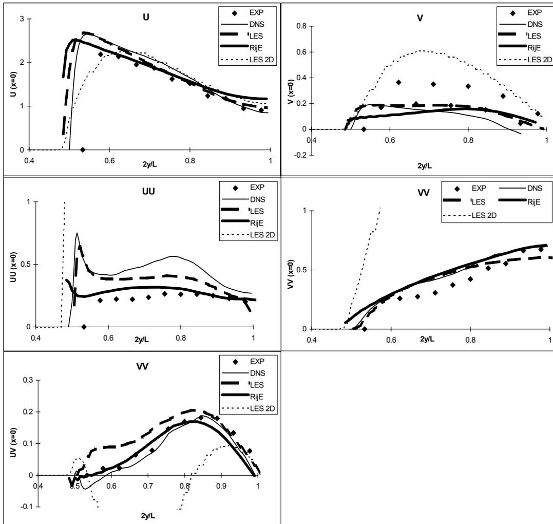
Figure 7 : Champs de vitesses et moments associés dans un faisceau quinconce de pas réduit 1.47 estimés par D.N.S, par L.E.S. 3D (Benhamadouche and Laurence 2003), avec un modèle Rij- $\epsilon$  3D, par L.E.S. 2D et expérimentalement par Simonin et Barcouda (1988).
