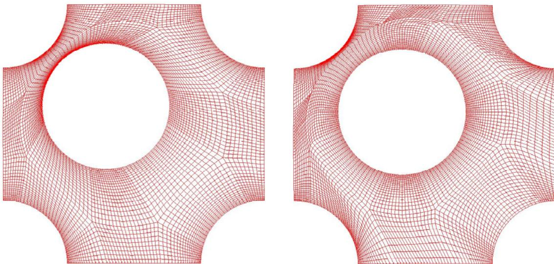
Figure 29 : Déplacement du maillage avec une viscosité de maillage constante (à gauche) et variable (à droite) par une méthode A.L.E. de type Laplacien.
