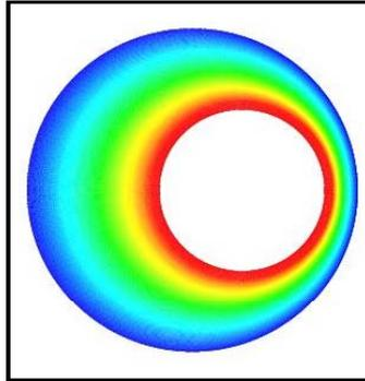
Figure 45 : Module du déplacement du maillage pour une configuration cylindres coaxiaux excentrés en fluide au repos, tube interne mobile libre et tube externe fixe.
