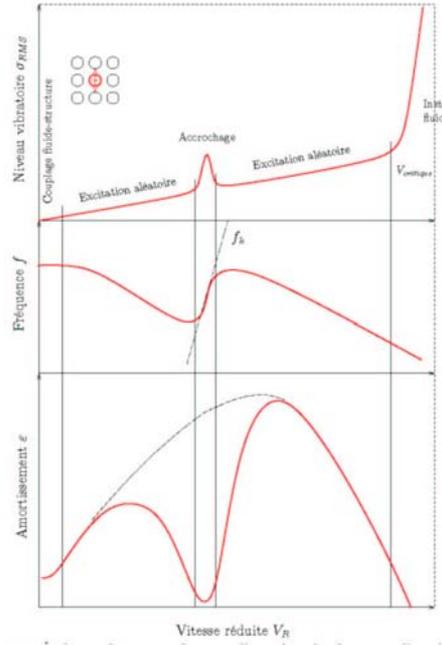
Figure 63 : Evolution du niveau vibratoire, de la fréquence et de l'amortissement d'un tube dans un faisceau de tubes en présence d'un écoulement transverse.
