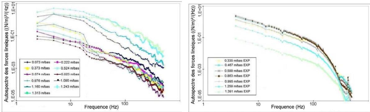
Figure 17 : Comparaison des autospectres d'excitations exercées sur le tube estimées numériquement par L.E.S. (à gauche) et identifiées expérimentalement sur maquette par méthode inverse (à droite) par Granger et Perotin (1997).
