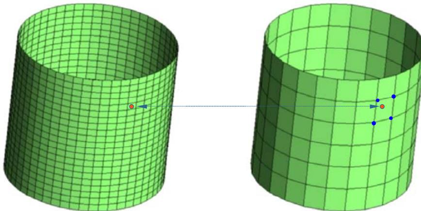
Figure 39 : Projection de données d'une grille à une autre.
