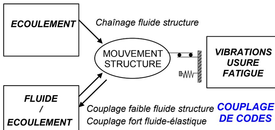
Figure 26 : Configuration de type couplage faible ou fort simulée par couplage de codes fluide et structure.
