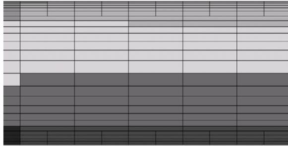
Figure 56 : Exemple de maillage non conforme.
