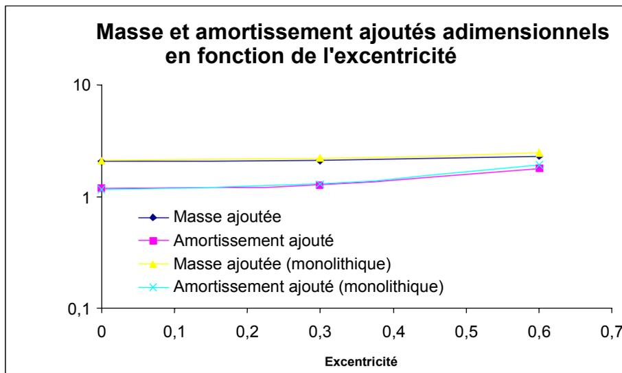
Figure 46 : Masse et amortissement ajoutés en fonction de l'excentricité. Comparaison entre la solution numérique obtenue avec Cosmethyc et par couplage monolithique (Chen et al. 1976, Yang et Moran 1979).
