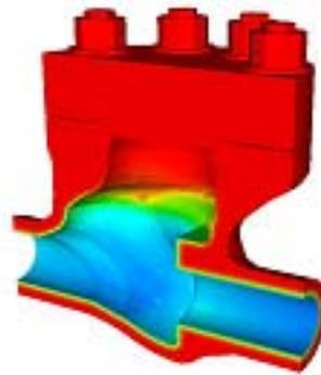
Figure 59 : Exemple de couplage fluide structure par le biais de chargements pariétaux thermiques (Péniguel et al.).
