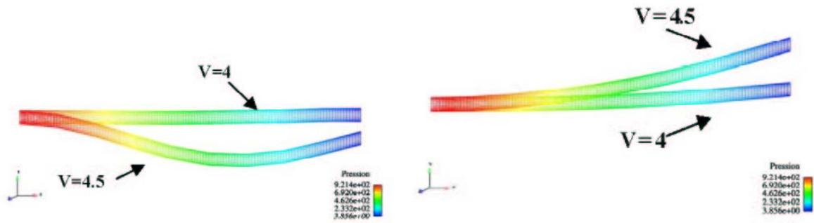
Figure 48 : Configuration de type cylindre flexible contenant un fluide en écoulement à différentes vitesses. Déformées du tube pour un vitesse réduite en-deçà de la vitesse critique de départ en instabilité (à gauche), au-delà (à droite).
