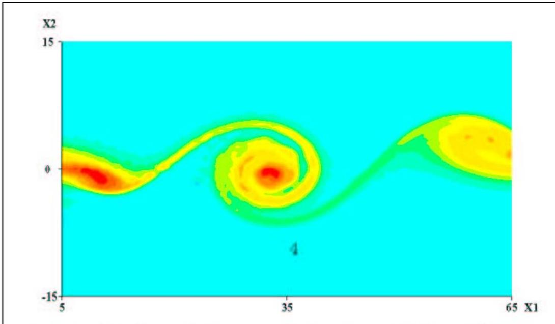
Figure 11 : Développement de la couche de mélange obtenu avec l'opérateur de propagation non linéaire : champ de vorticit .
