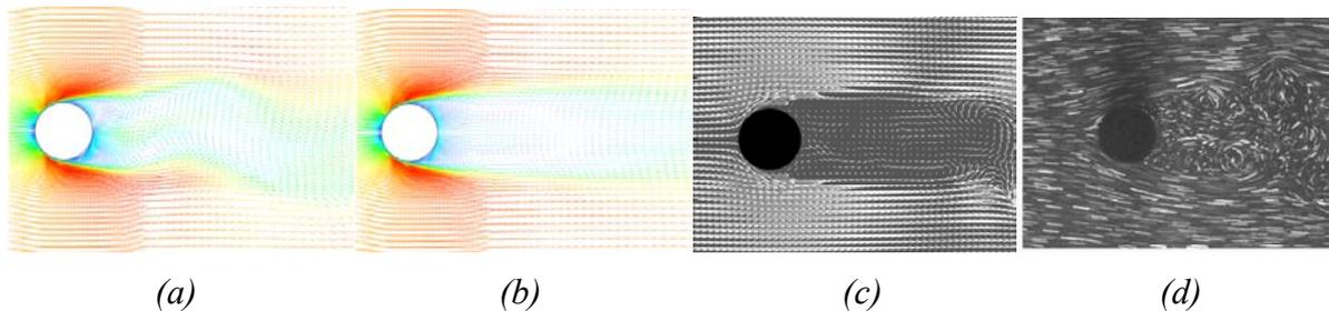
Figure 54 : Ecoulement derrière un cylindre : (a) LES, (b) LES moyennée, (c) DES, (d) Expérimental (Afgan et al. 2005).
