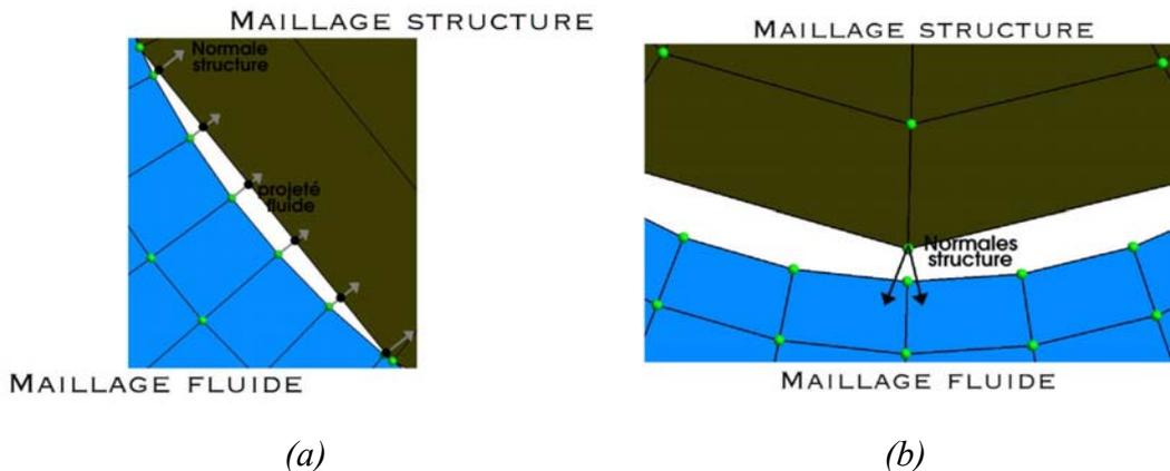
Figure 41 : (a) Méthode de projection basée sur le calcul des normales des faces maître à l'interface dans le cas où la structure est considérée comme maître. (b) Exemple de non unicité du projeté par la méthode des normales dans le cas où la structure est considérée comme maître.
