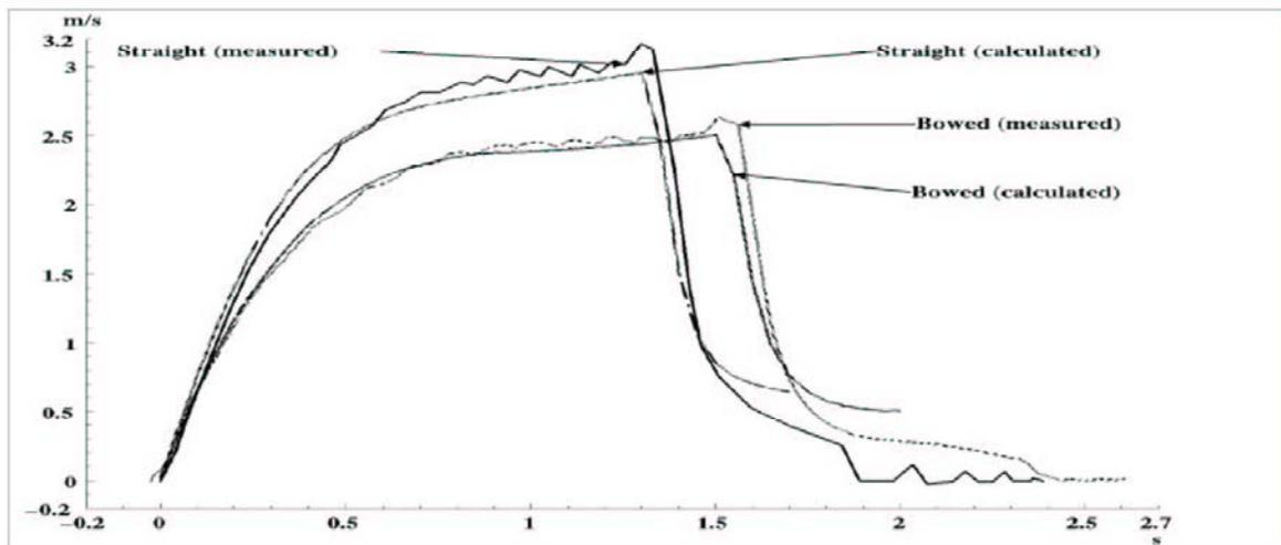
Figure 25 : Comparaison des cinétiques de chute de grappe calculées et mesurées pour une grappe s'insérant dans un canal droit et dans un canal déformé.
