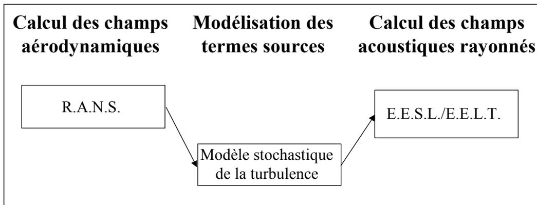
Figure 20 : Procédure de chaînage possible pour l'aéroacoustique : modélisation de la turbulence, des sources acoustiques induites puis du bruit rayonné.
