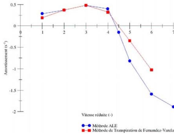
Figure 51 : Amortissement des vibrations du cylindre en fonction de la vitesse réduite estimée avec Cosmethyc et avec une méthode de transpiration (Fernandez Varela 2001).
