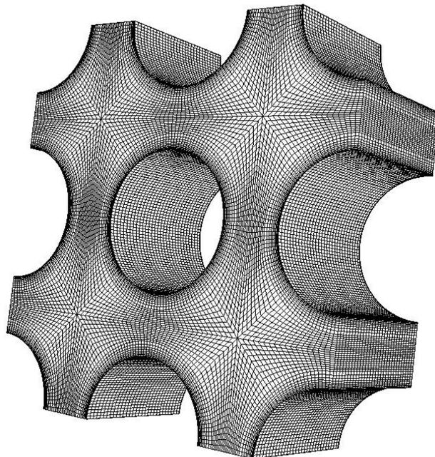
Figure 5 : Exemple de maillage tridimensionnel pour la simulation des écoulements transverses dans un faisceau de tubes périodique à pas carré droit ou quinconce.
