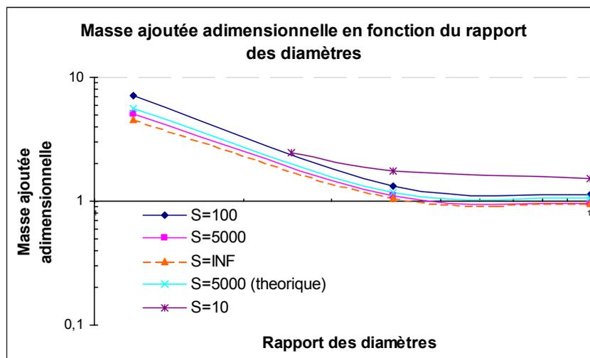
Figure 43 : Masse ajoutée en fonction du rapport des diamètres des tubes coaxiaux pour différents nombres de Stokes en fluide visqueux (10, 100, 5000) et non visqueux (infini). Comparaison entre les solutions numériques et analytiques (Chen et al. 1976).
