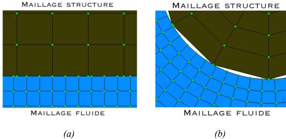
Figure 40 : (a) Exemple d'interface jointe entre maillages fluide et structure. (b) Exemple d'interface disjointe entre maillages fluide et structure.
