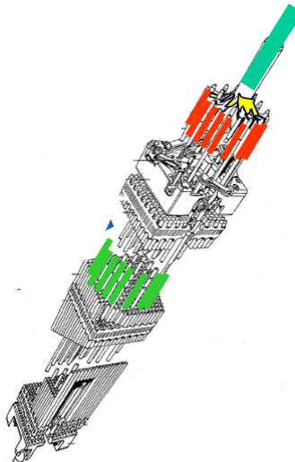
Figure 24 : Représentation d'une grappe de commande insérée dans un assemblage combustible.
