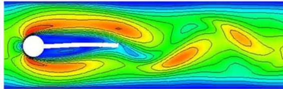
Figure 61 : Exemple de départ en grand déplacement d'une lame flexible en aval d'un cylindre en présence d'un écoulement transverse (Hron et Turek 2006).
