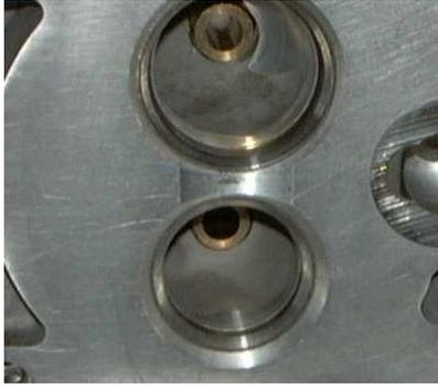
FIG. 3.10 – Face flamme de la culasse monocylindre
