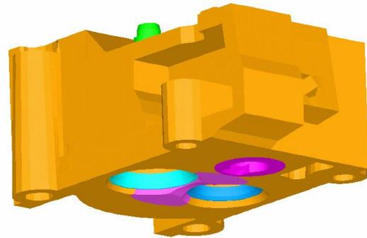
FIG. 3.7 – Schéma de la culasse mono-cylindre.
