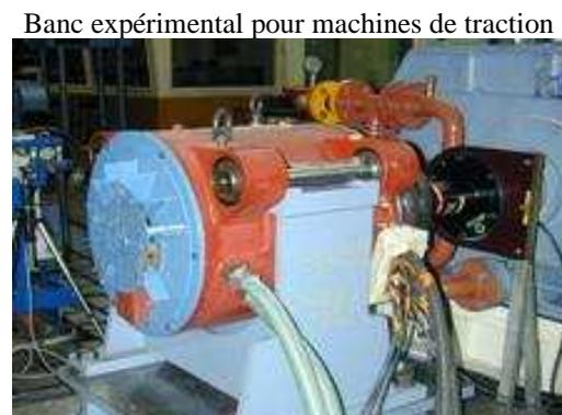
Figure 12 : Machines asynchrones appliquées à la traction ferroviaire.
