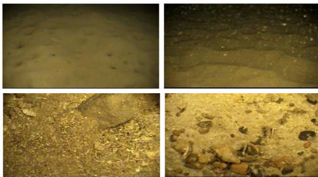
Figure 4: Photos du haut : prise de vue  partir d'une camra vido sur le fond avec un grand angle de perspective. Photos du bas : prise de vue  partir d'une camra vido sur le fond avec un angle plus troit de perspective orient sur le fond (D'aprs White et al. , 2007).
