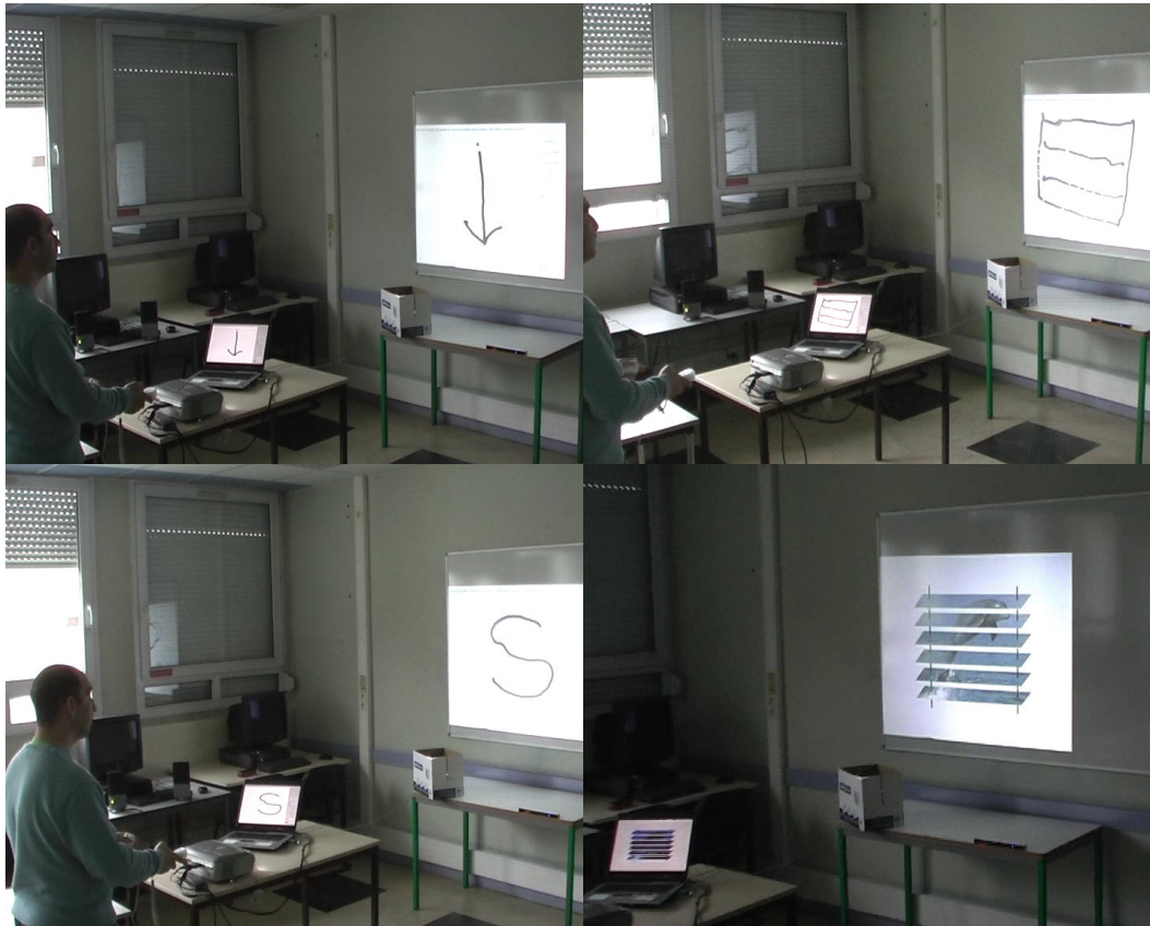
Figure 30 : L'utilisateur enchaîne des mouvements afin que le système déclenche l'action correspondante à la phrase « Descendre le store de la salle de bain »
