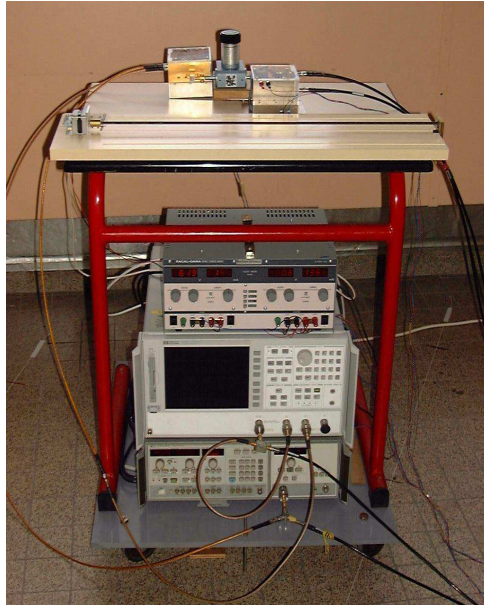
FIGURE 2.4 – Sondeur de canal pour les mesures à 60 GHz. Il est basé sur un analyseur de réseau vectoriel.
