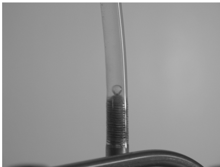
FIG. B.7 – Dispositif permettant d'observer la première bulle de gaz qui traverse le matériau poreux initialement complètement saturé en eau, dès la pression seuil de pénétration atteinte.
