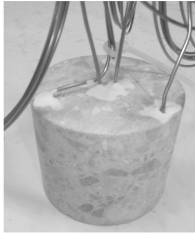
FIG. B.4 – Echantillon de béton CERIB (diamètre 65mm) instrumenté de différents thermocouples situés à proximité de sa surface ou à cœur, afin d'évaluer l'uniformité de la température imposée par la cellule triaxiale thermique, voir [Chen et al., 2007].
