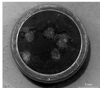
**figure III.1.** : Nettoyage par désorption laser sélective à 532 nm de la surface d'un échantillon de glace polluée par des suies. Les tâches claires correspondent à la surface traitée [Mihesan 2005b]
