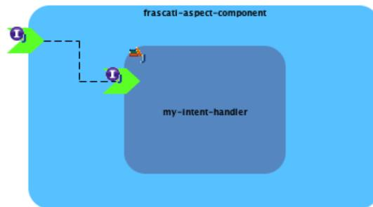
FIGURE 2.10 – La structure minimale d’un composant d’aspect FRASCATI.
