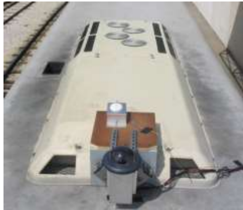
Figure 32. Dispositif expérimental PREDISSAT composé des deux générations de systèmes d'acquisitions d'image et d'une antenne GNSS.
