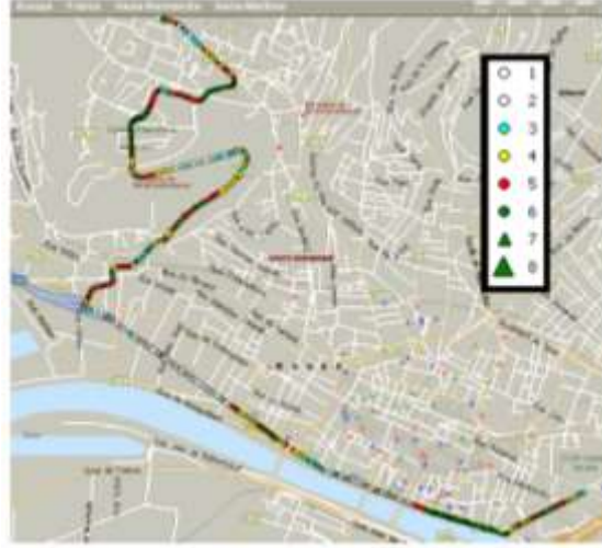
Figure 34. Nombre de satellites minimal reçus par le bus ANGO lors d'un trajet, quelle que soit l'heure de son passage, d'après PREDISSAT [CI53].
