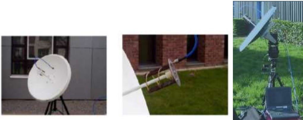
Figure 18. Dispositif de mesure expérimentale des signaux NLOS avec une antenne polarisée [T1]
