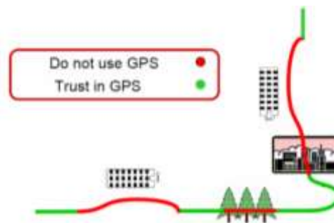
Figure 40. Principe de fonctionnement d'une base de données de confiance le long d'une trajectoire connue (exemple d'une ligne de bus ANGO).
