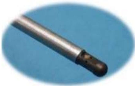
Figure 5.19 Banc d'essais équipé de la sonde 3 trous (CHERDIEU, 2014)
