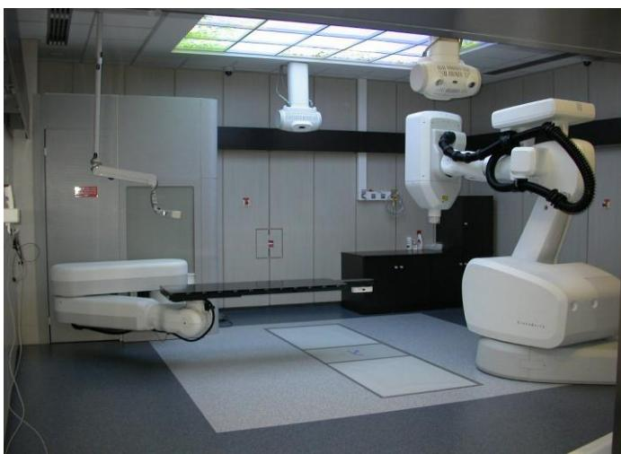
Figure 7: Salle de traitement du Cyberknife : Le Linac est monté sur un robot Kuka et peut bouger avec 6 degrés de liberté autour du patient sur des nœuds prédéfinis. La table est robotisée avec 5 degrés de liberté. Des images de projection sont prises utilisant les deux tubes rayons X montés au plafond et les deux détecteurs intégrés au sol.
