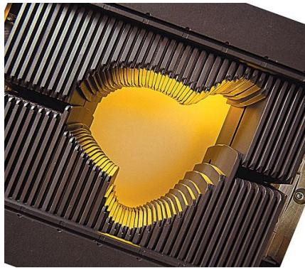
Figure 2: MLC : Chaque lame peut être positionnée individuellement, offrant la possibilité de sculpter le faisceau conformément avec la géométrie de la cible.
