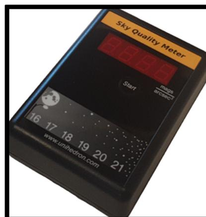
Figure 42 : SQM-L, permettant de prendre les mesures.
