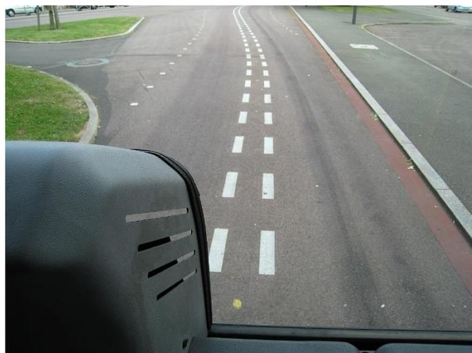
Figure 23 : Marquage lu et interprété par un guidage optique sur un véhicule TEOR à Rouen, Source : Wikipédia, 2008
