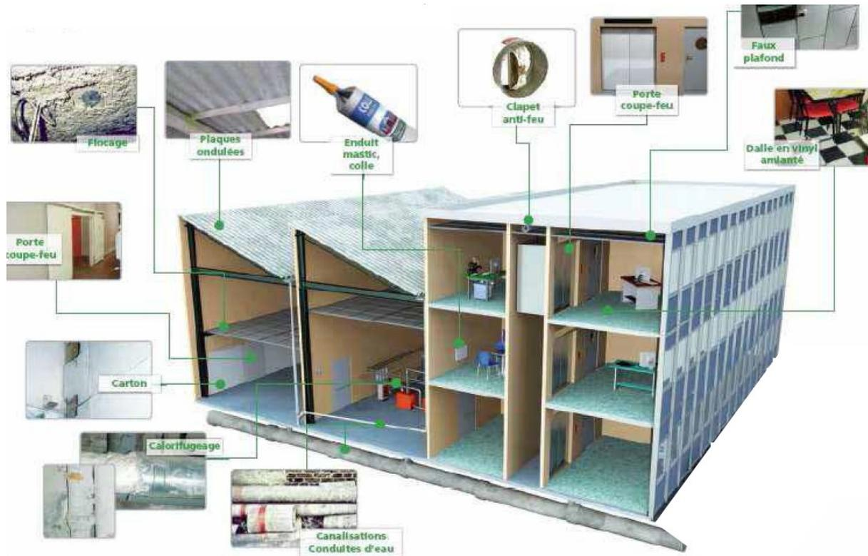
Figure 2 : exemples de présence d'amiante dans un bâtiment (source : CARSAT)
