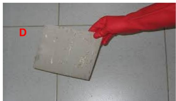
Figure 3 : Illustrations de présence d'amiante
