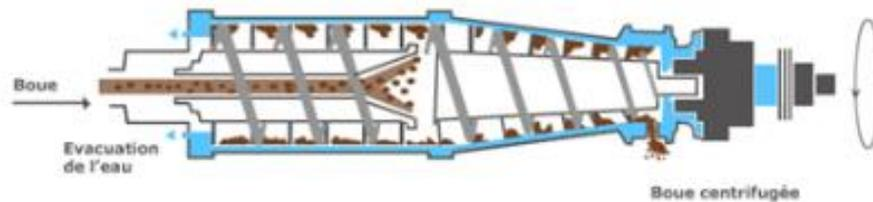
Figure 6 : Schéma d'une décanteuse par centrifugation [36]
