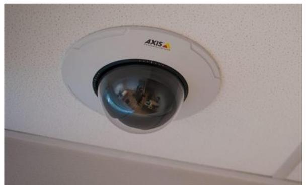
Figure 5 : Photographie de la caméra dôme 360° utilisée pour les téléconsultations
