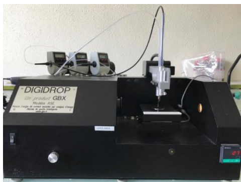
Figure 7: Goniomètre pour mesure de l'angle de contact
