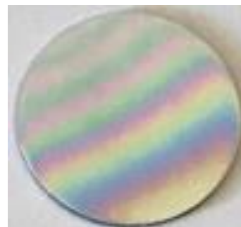
Figure 14: Irisations sur coupon revêtu à base de TMDS
