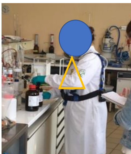
Photo 11 : PID positionné dans l'aire de la zone respiratoire de la technicienne
