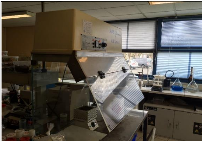
Photo 5 : Hotte à filtration et armoire métallique sous clé pour le rangement des bases
