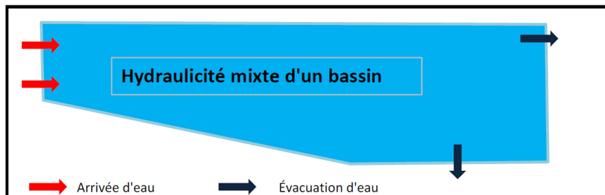
Illustration n° 4 : Schéma du circuit d'hydraulicité mixte, d'après [5]
