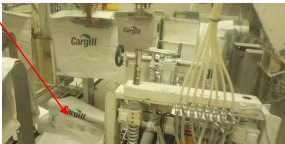
Figure 26. Problème d'ouverture de sacs et de réglage de la chaise
