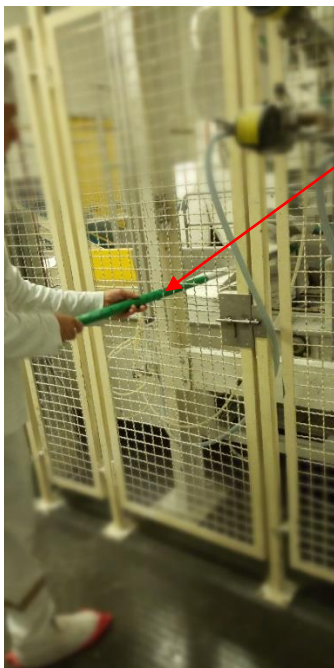
Tige de balaie pour séparer les sacs entre eux et les remettre correctement sur le tapis
