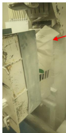
Figure 26. Problème d'ouverture de sacs et de réglage de la chaise
