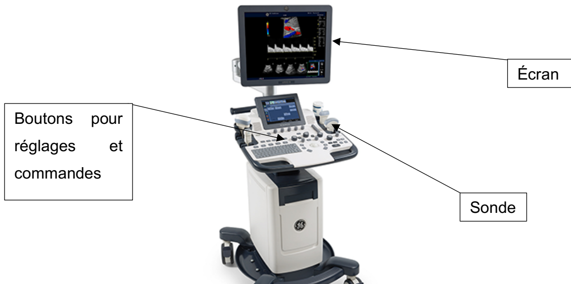
Figure 3 Illustration des éléments composant un échographe
