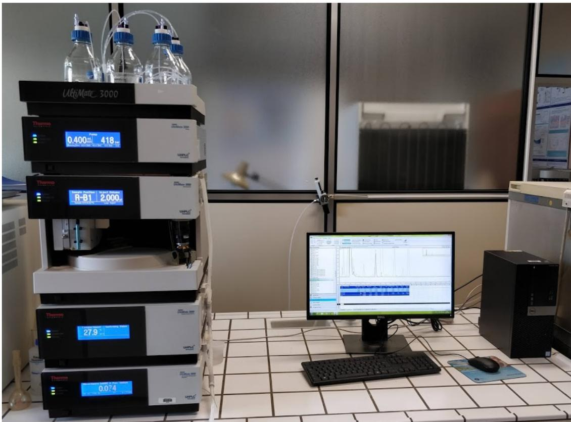
Figure 6 : Chromatographie liquide haute performance détection UV (HPLC-UV)
