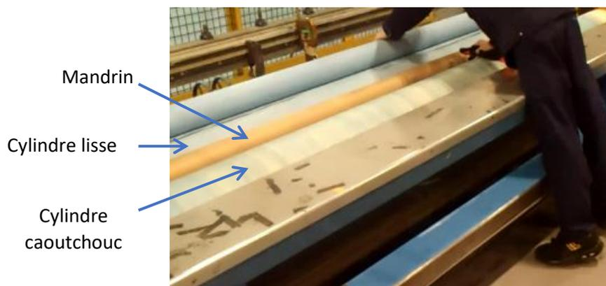
Une fois la préparation finie, il règle les guides mandrins de deux cotés, pour bien serrer la bobine lorsqu'elle tourne. La manipulation des guides se fait latéralement et en les poussant vers l'arrière afin de pouvoir préparer l'enroulage. Une fois la préparation de l'enroulage terminée, l'opérateur bascule les guides mandrin vers l'avant et les règle latéralement de manière à ce qu'ils soient en contact avec les cônes. Cette action a fait l'objet d'une étude de
