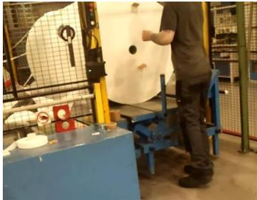
Dans le cas des grandes bobines, l'opérateur positionne le chariot devant l'enrouleuse et la tombée de la bobine finale s'effectue automatiquement sur le chariot.
