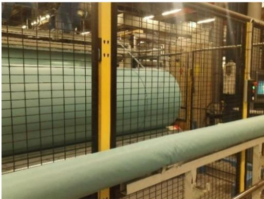
Visuel superposition : l'opérateur est du côté de l'enroulage de la bobine ce qui lui permet de mieux voir le défaut. Dans ce cas de figure, la vitesse est diminuée pour qu'il puisse arrêter la machine au bon moment.
