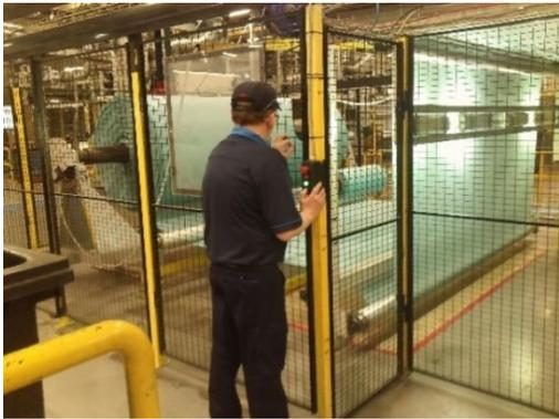
Un visuel direct : l'opérateur surveille la bobine et il peut tourner à haute vitesse jusqu'au moment où il voit le défaut arriver. (A l'aide des sonnettes)
