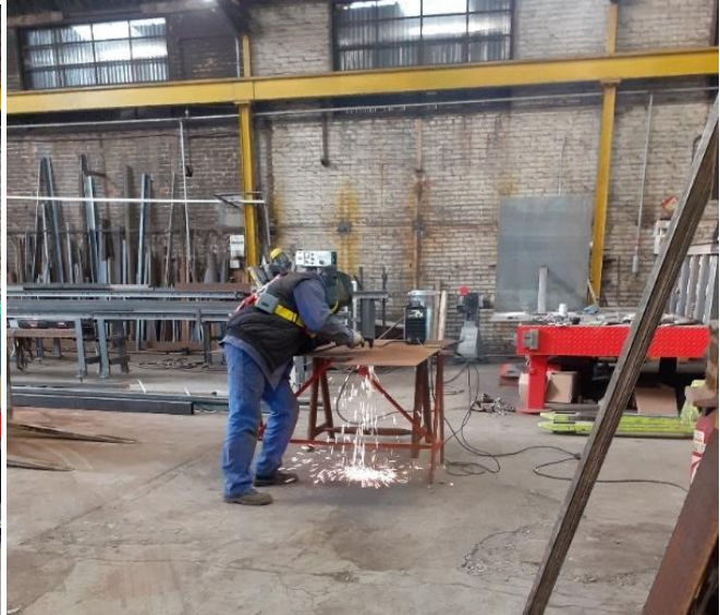
Découpe plasma manuelle par le soudeur 10
