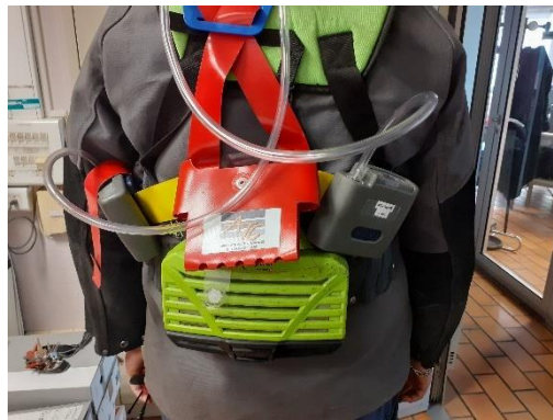
Figure 6: Dispositif de captage de dos
