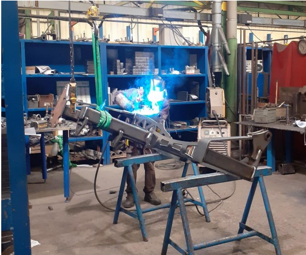
Soudage de pièce en acier
