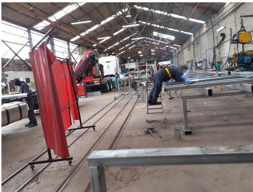
Soudage MAG poste suite confection châssis
