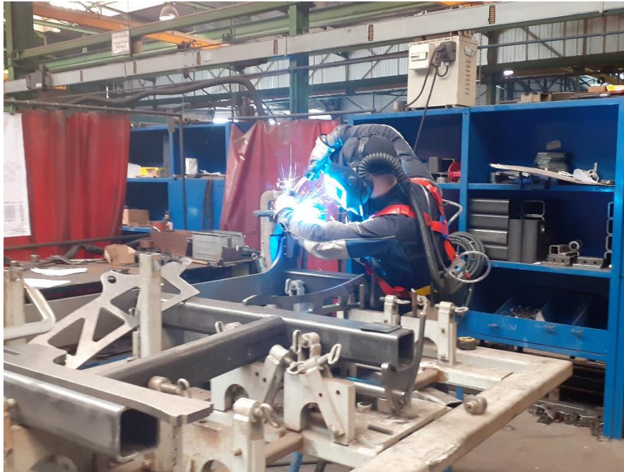
Pointage sur châssis latéral en acier
