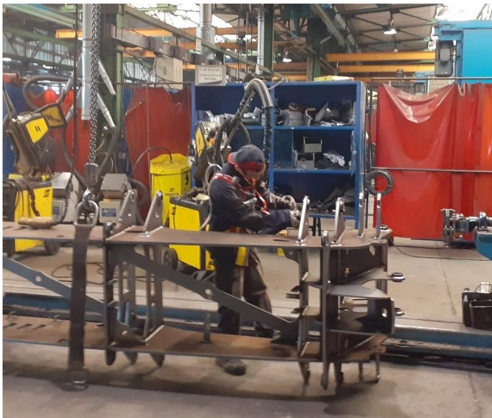
Soudage sur châssis central
