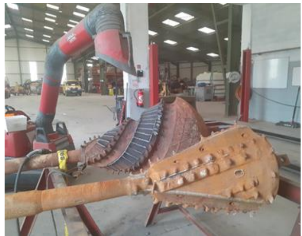
Les aléseurs en cours de soudage
