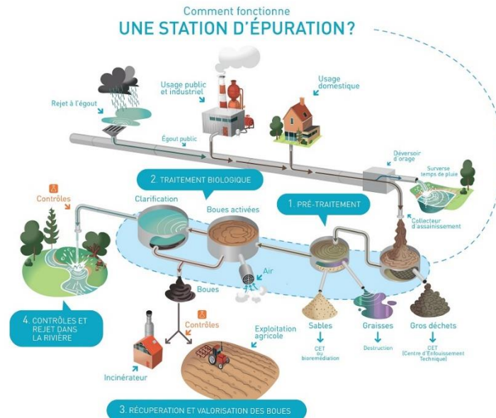
Figure 4 : Fonctionnement d'une station d'épuration
