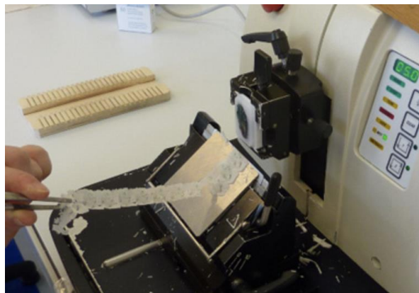
Illustration 3 : Coupe à l'aide d'un microtome
