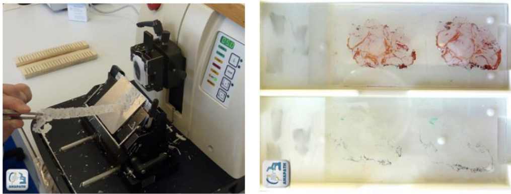
Figure 6: Coupe au microtome (gauche) et lame avec et sans coloration (droite)
