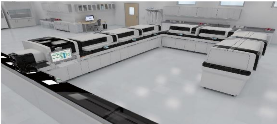
Figure 7 : Photographie d'un Atellica Solution, composé de un Sample Handler, cinq analyseurs Atellica CH930, deux analyseurs Atellica IM1300
