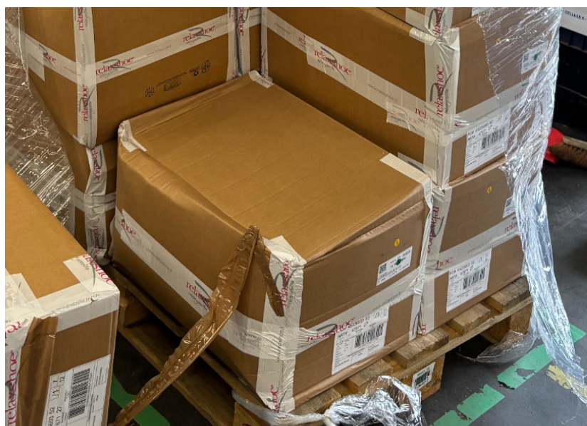
Figure n°8 : Photographie des colis affaissés en bas de palette
