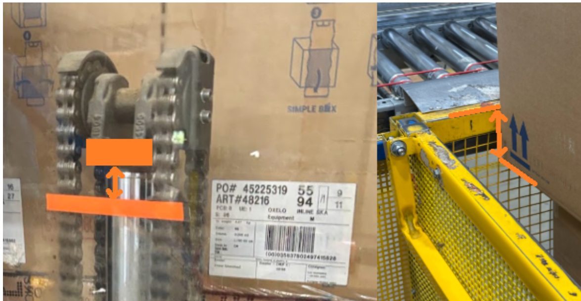
Figure n° 11 : Défaut de calibrage au niveau de l'engin et de la plateforme
