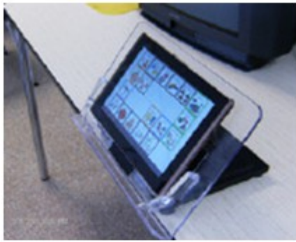
La tablette sur un support en plexiglas. Fixation à l'arrière à l'aide de Velcro.
