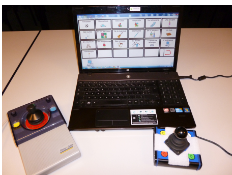
Plaphoons sur PC en mode souris avec deux types de joysticks différents
