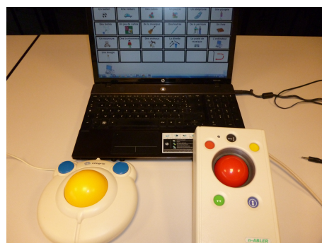
Plaphoons sur PC en mode souris avec deux types de trackballs différents
